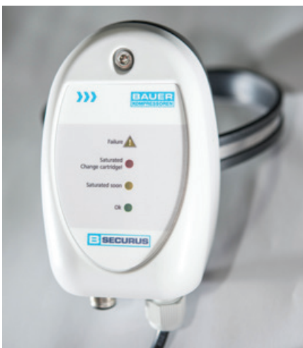
B-SECURUS : mesure de la saturation de la cartouche et affichage de la durée de vie restante de la cartouche à filtre via un système de feu tricolore
